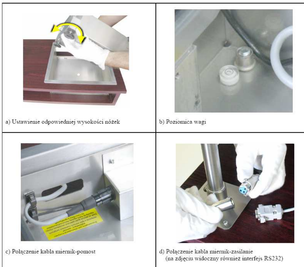
Rys. 9 Przykład umieszczenia pomostu wagi oraz połączenie kabli modułów.
