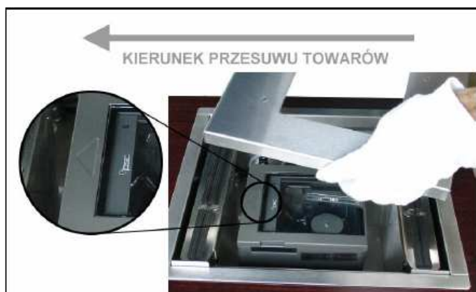
Rys. 16. Czytnik Magellan 2300 HS umieszczony w pomoście
