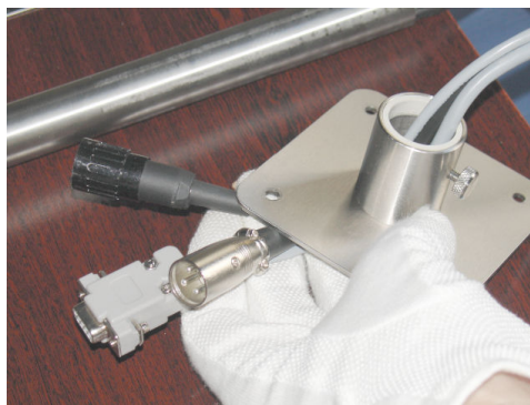
b) Podstawa miernika wraz z kablami
