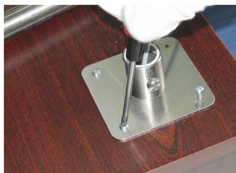
c) Przykręcenie podstawki miernika
